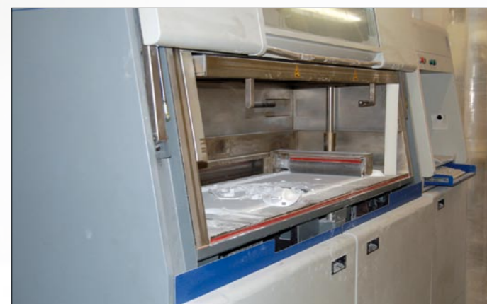
Eén van de SLS-machines waarover Amitek beschikt.
