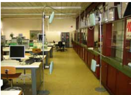
Figuur 2 : Overzicht van enkele testopstellingen voor de uitleessnelheid, -afstand en -nauwkeurigheid bij RFID.
