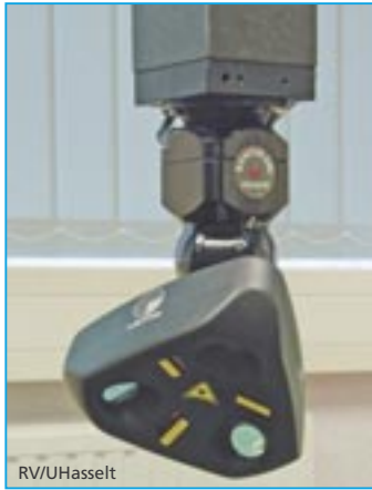
Detail van de 3D-laserscanner op een 3D-coördinatenmeetmachine.
